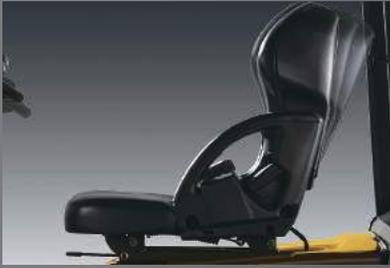
**5** **Tren de potencia aislado y asiento con suspensión completa**
